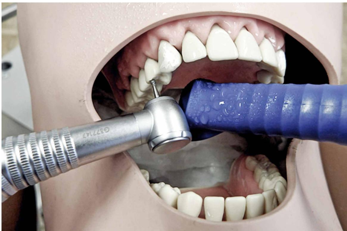
Versuchsaufbau mit optimaler Absaugposition mit der Absaugkanüle Universalkanüle Protect. Die Durchflussrate wurde am Schieber des Saughandstücks eingestellt.
