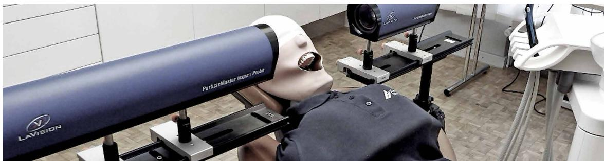
Messaufbau mit Einheit für Hintergrundbeleuchtung links und Optik rechts neben dem Phantomkopf. Das optische Messfeld befindet sich 5 cm über Zahn 11.
