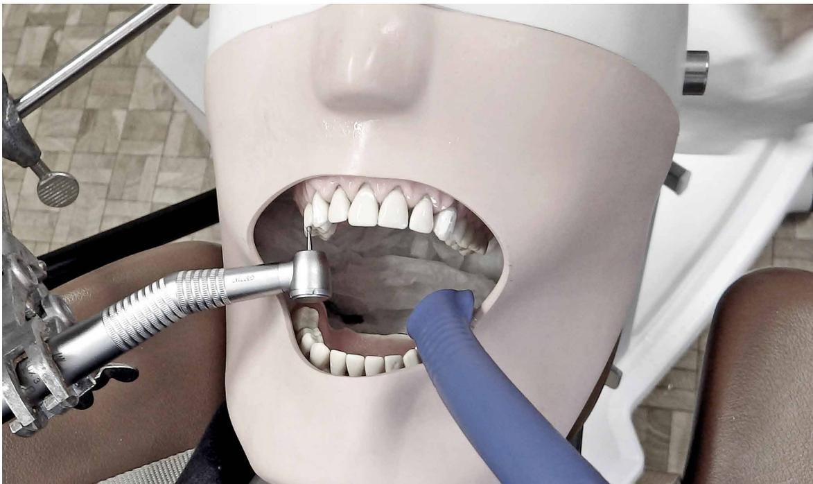
Versuchsaufbau mit suboptimaler Absaugposition mit der Absaugkanüle Universalkanüle Protect. Die Durchflussrate wurde am Schieber des Saughandstücks eingestellt
